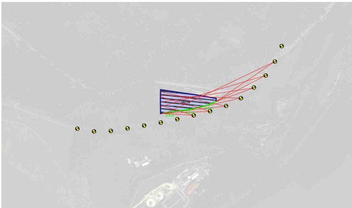
Durch die Ausrichtung der Module auf 186° Süd bei 15° Aufneigung und durch die durch den Sichtschutz begrenzten möglichen Höhenwinkel treten in dieser Situation in Richtung der relevanten Sichtfelder der vermerkten Beobachter nur Reflexionen bei tief stehender Sonne auf, die aus Sicht dieser Beobachter unter kleinen Blickwinkeldifferenzen zur Sonne gesehen werden.
